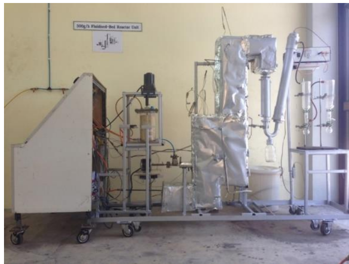
รูปที่ 4-2 ชุดเครื่องผลิตไบโอออยล์ด้วยกระบวนการ Fast Pyrolysis
