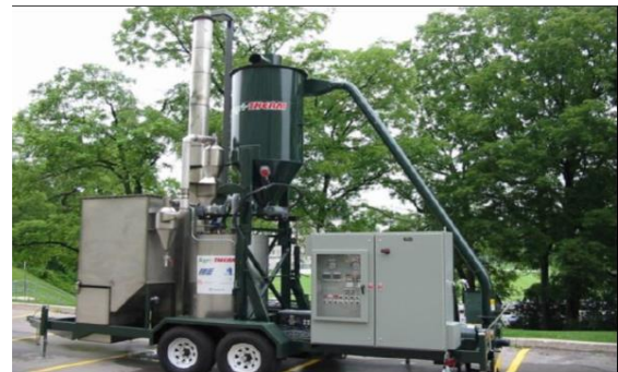
รูปที่ 3-5 โรงงาน Fast Pyrolysis ที่เคลื่อนที่ได้ขนาด 10 ตันต่อวัน ของบริษัท Agri-Therm [15, 16]
