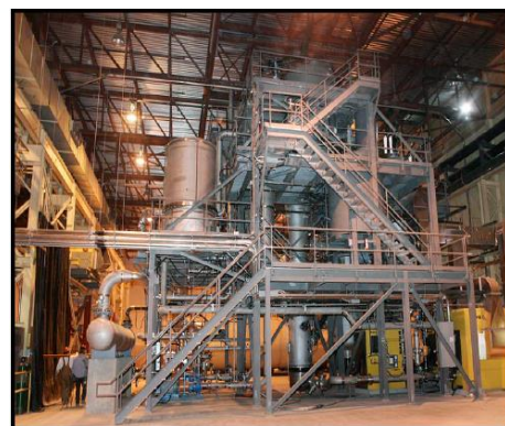
รูปที่ 3-3 กระบวนการผลิตและโรงงานขนาด 100 ตันต่อวัน ของบริษัท Ensyn [11, 12]
