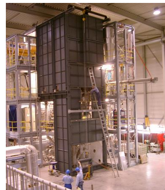
รูปที่ 3-6 กระบวนการและโรงงาน Fast Pyrolysis ของบริษัท BTG ที่ตั้งอยู่ที่ประเทศมาเลเซีย [17]
