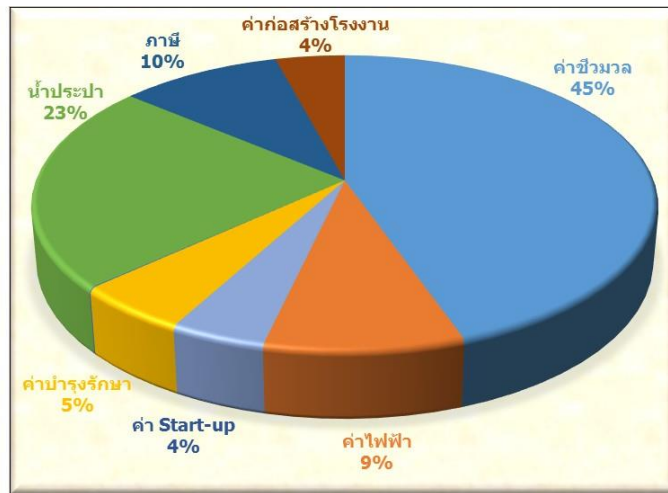
รูปที่ 5-1 สัดส่วนของค่าใช้จ่ายเฉลี่ยที่ใช้ในการผลิตน้ำมันเชื้อเพลิงสังเคราะห์เทียบเท่าน้ำมันเตาจากกระบวนการ Fast Pyrolysis
