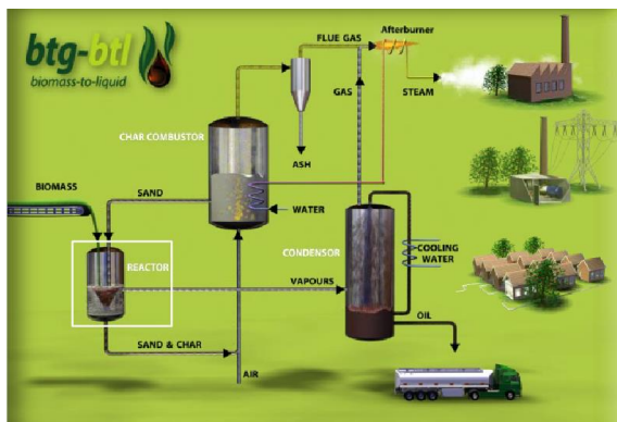
รูปที่ 3-6 กระบวนการและโรงงาน Fast Pyrolysis ของบริษัท BTG ที่ตั้งอยู่ที่ประเทศมาเลเซีย [17]
