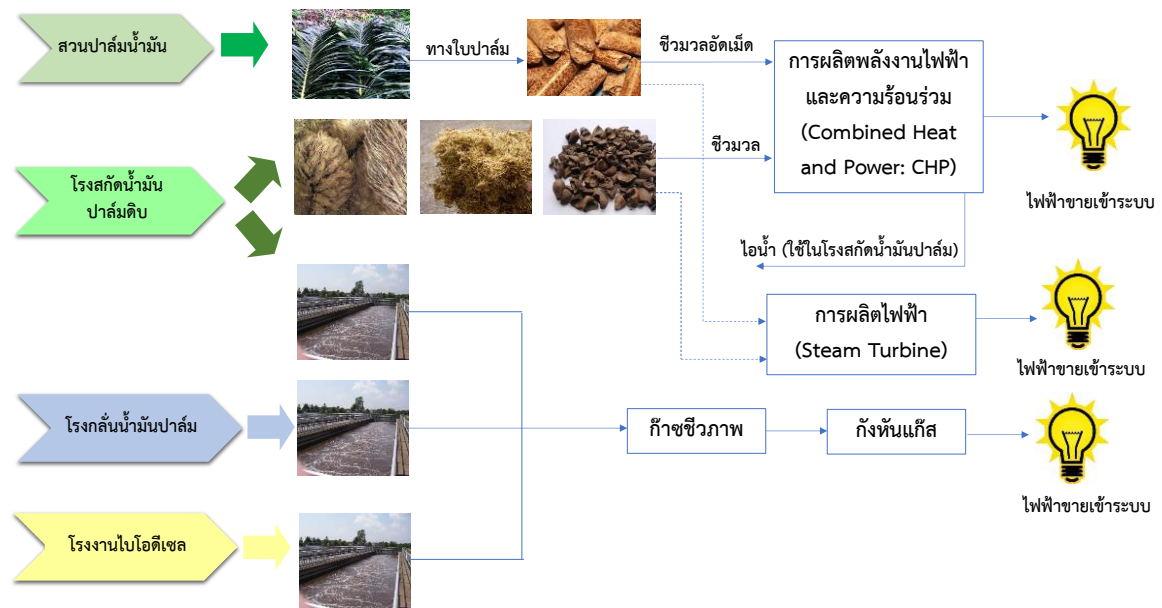
ภาพที่ 3 แนวทางขยายการใช้ประโยชน์วัสดุเหลือใช้ ของเสียจากปาล์มน้ำมันในด้านไฟฟ้า และความร้อน
