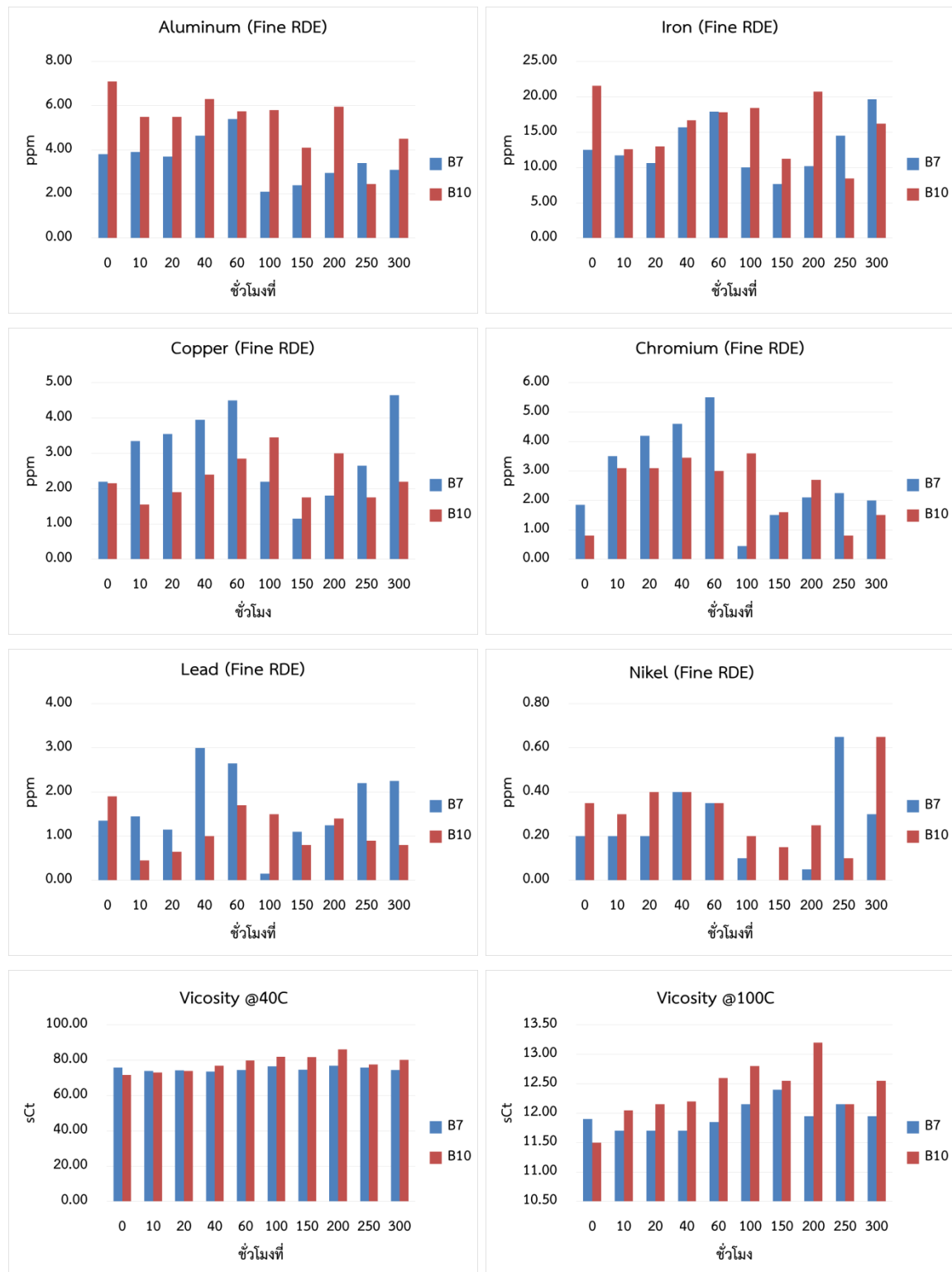
รูปที่ 7 การวิเคราะห์ความสึกหรอจากน้ำมันหล่อลื่นของรถยนต์ทดสอบในห้องปฏิบัติการ
