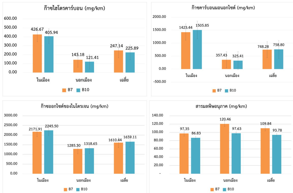
รูปที่ 12 ค่าการปลดปล่อยมลพิษของรถยนต์ทดสอบภาคสนาม
