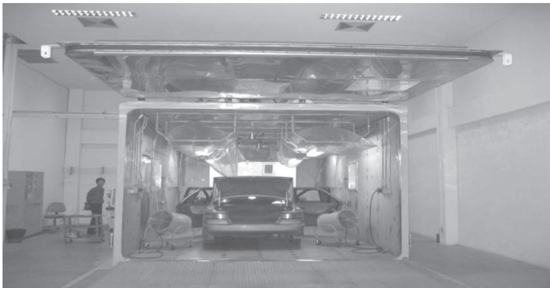
รูปที่ 5 ห้องทดสอบเพื่อตรวจวัดไอระเหยน้ำมันเชื้อเพลิงจากรถยนต์ สถาบันยานยนต์
