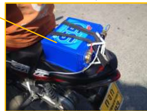
GPS-based Vbox: วัดความเร็วและความเร่งของรถ
