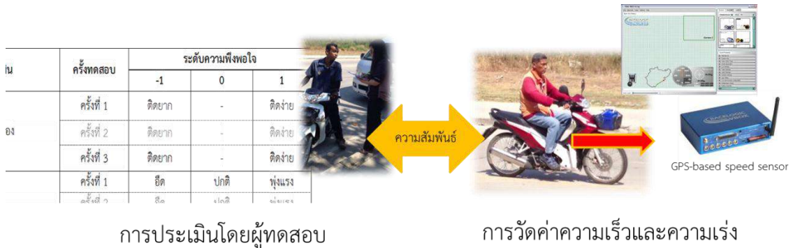
รูปที่ 4-4 การหาความสัมพันธ์ระหว่างการประเมินด้วยความรู้สึกของผู้ขับขี่ (Subjective Evaluation) และการประเมินจากตัวเลขที่วัดได้ (Objective Evaluation)
