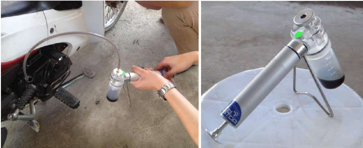
รูปที่ 4-20 การเก็บตัวอย่างน้ำมันหล่อลื่นจากรถทดสอบ
