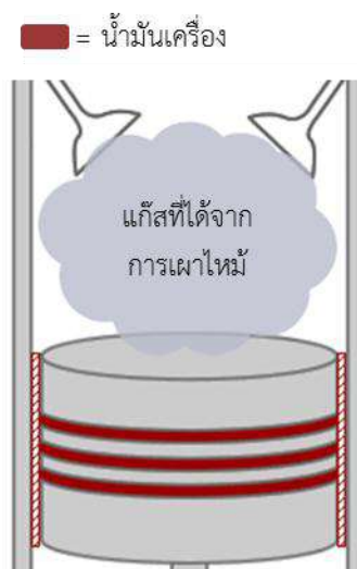
รูปที่ 2-17 การป้องกันการรั่วของกำลังอัดเครื่องยนต์
