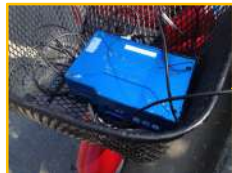
GPS-based Vbox: วัดความเร็วและความเร่งของรถ
