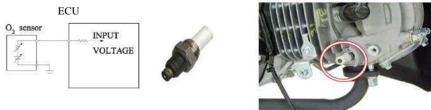
รูปที่ 2-10 อุปกรณ์วัดปริมาณออกซิเจน (O 2 sensor) (8)
