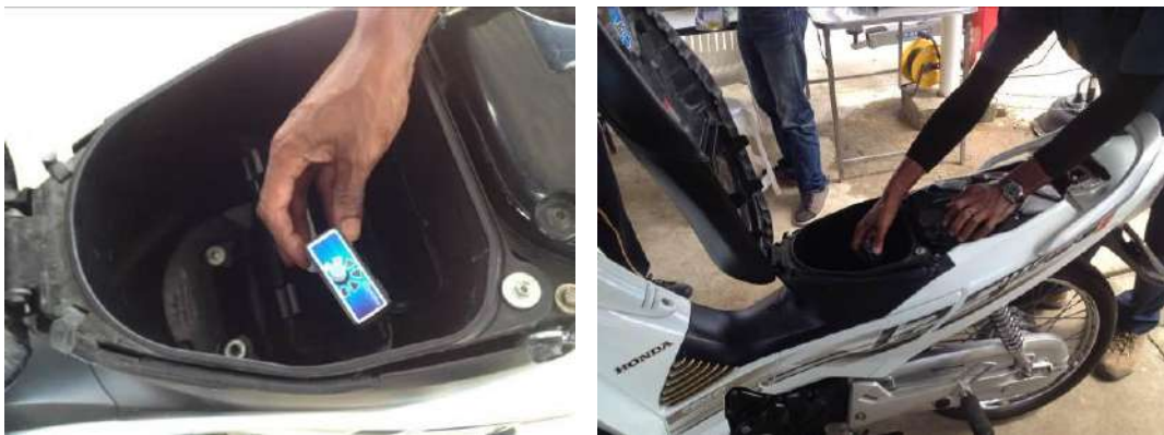
รูปที่ 3-4 ตำแหน่งการติดตั้งตัวอย่างชุดอุปกรณ์เสริม FFV conversion kit ในรถจักรยานยนต์
