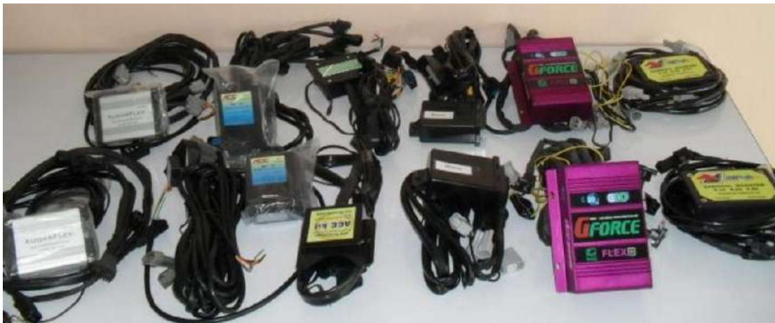
รูปที่ 2-12 ตัวอย่างชุดอุปกรณ์เสริม FFV conversion kit ของผู้ผลิตต่าง ๆ (9)
