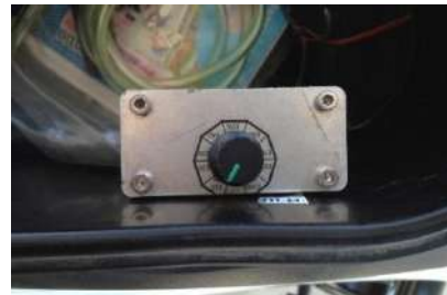
(6) เลือกชนิดเชื้อเพลิงที่ชุด FFV Conversion Kit
